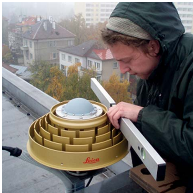
Obr. 2 Instalace antény Leica AR25 v síti CZEPOS ve Znojmě, anténa umožňuje příjem signálů Galileo
