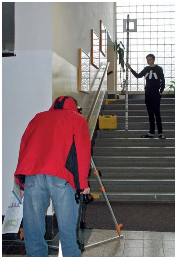
Obr. 2 Měření nivelačním přístrojem
