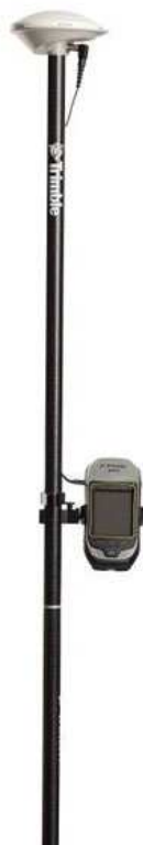
Obr. 3 Rover GNSS Trimble na výtyčce, uprostřed kontroler s integrovaným přijímačem i anténou, nahore externí anténa.
