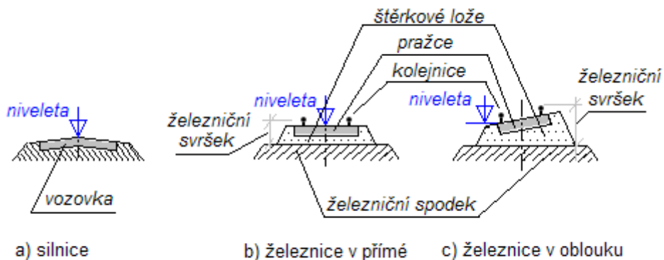
Obr.4 Umístění nivelety u silnice a železnice
