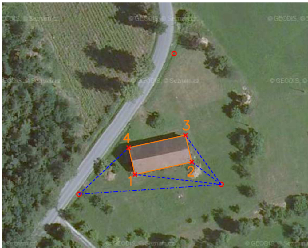
Obr. 3 Podrobné zaměření stavebních objektů (ukázka použití prostorové polární metody)
