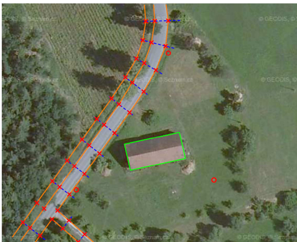
Obr. 4 Podrobné zaměření liniových prvků pomocí příčných řezů (zaměření komunikací)
