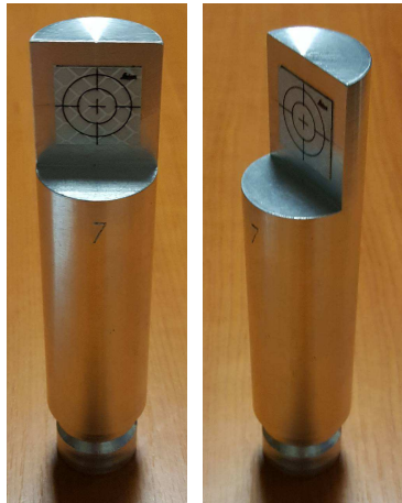
Obr. 3.2 Cílový terč s odraznou fólií
