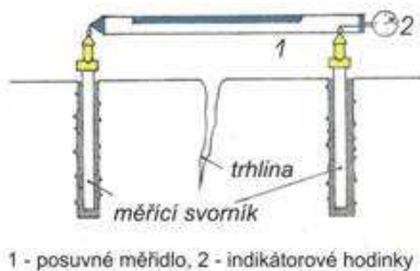
Obr. 6.1.1.3.1a Schéma trhlinoměru (Kořínek, Aldorf, 1993)
