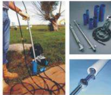
Obr. 6.1.2.1.a Příklad inklinometrické sondy (Sisgeo, 2003)
