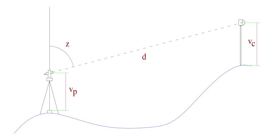
$$Z_{p} = Z_{s} + v_{p} + d.\cos z - v_{c}$$
