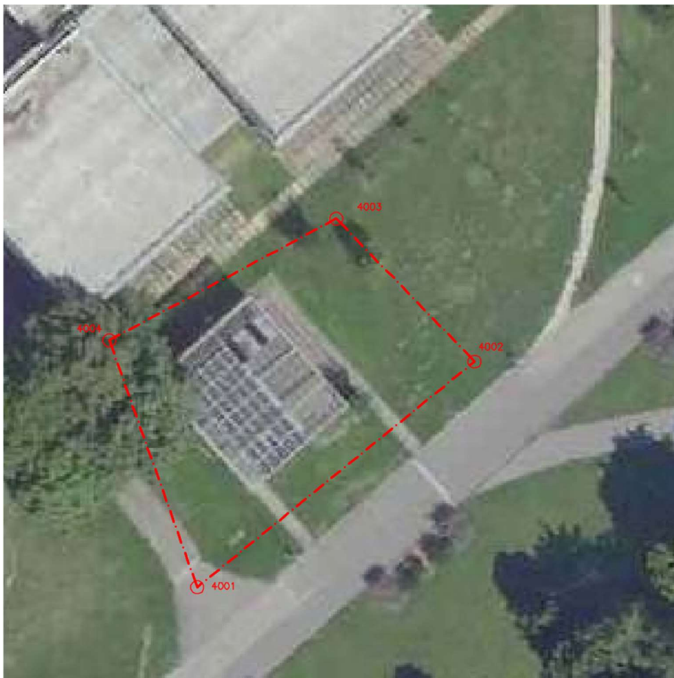
Obr. 2 Stabilizace a zaměření měřické sítě
