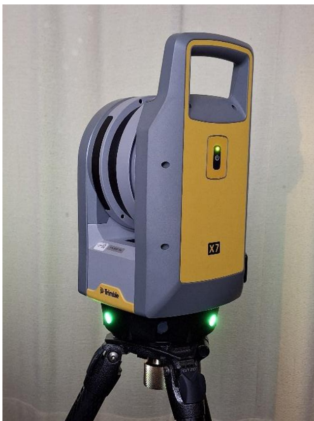
Obr. 1 Skener X7 – ovládací tlačítko z boku přístroje, zeleně svítící diody
