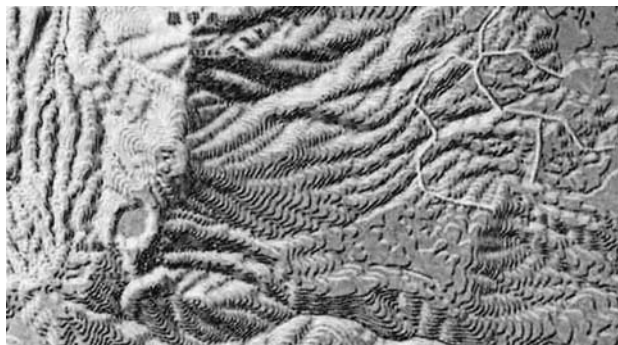
Obr. 19 Sugestívna aplikácia metódy osvetlených/tieňovaných vrstevníc [6]
