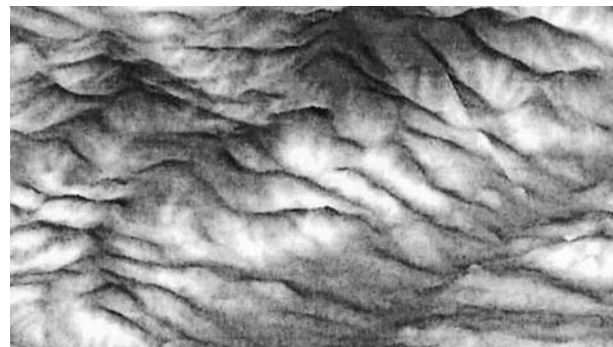
Obr. 23 Tieňovanie na báze digitálneho modelu georeliéfu [3]
